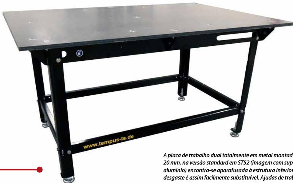
A placa de trabalho dual totalmente em metal montada de 12 a 20 mm, na versão standard em ST52 (imagem com superfície de alumínio) encontra-se aparafusada à estrutura inferior e em caso de desgaste é assim facilmente substituível. Ajudas de trabalho, como por exemplo, tornos de apertar, dispositivos podem ser montados de forma simples e sólida.
