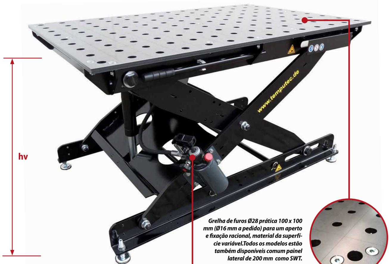
Grelha de furos Ø28 prática 100 x 100 mm (Ø16 mm a pedido) para um aperto e fixação racional, material da superfície variável. Todos os modelos estão também disponíveis com um painel lateral de 200 mm como SWT.
