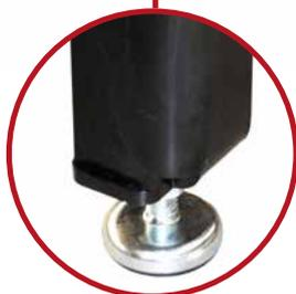
*Uma estrutura inferior maciça num perfil de 8mm com rebordo e pés niveladores M16 de 0 a 70mm com uma capacidade de carga de até 2,8KN (por favor observar a capacidade de carga total do modelo da mesa) garante uma estabilidade segura mesmo em superfícies irregulares*
