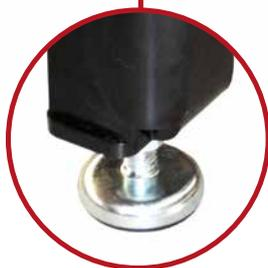
Uma estrutura inferior maciça de até 8 mm Perfil com rebordo e pés niveladores M16 de 0 a 70 mm com uma capacidade de carga de até 2,8 KN (por favor observar a capacidade de carga total do modelo da mesa) garante uma estabilidade segura e nivelada mesmo em superfícies não planas.
