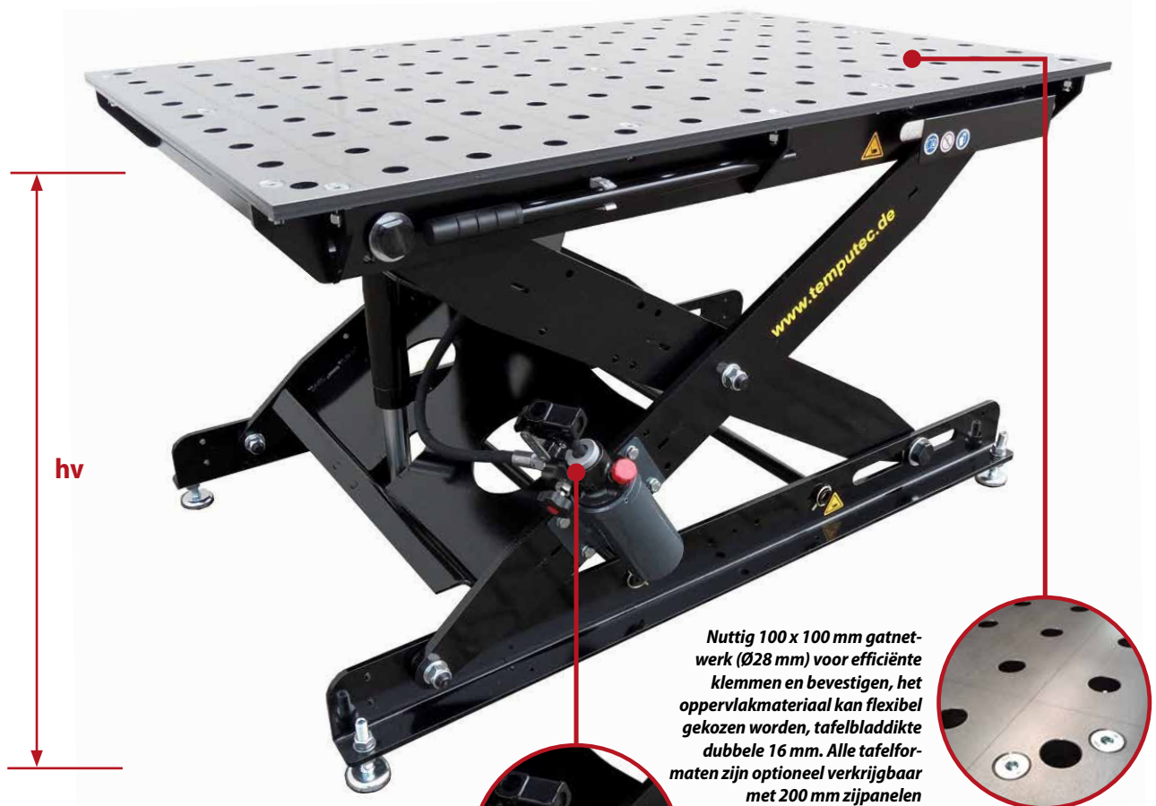
S Afb.: Temputec SST 65-105/16 S met hydraulische hoogteverstelling van 650 tot 1.050 mm, Maat werkoppervlak 1,400 x 900 mm, standaard kleur zwart
