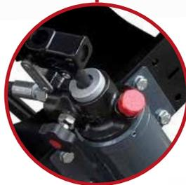
**Hydraulische Höhenverstellung mittels einfach wirkender 200 bar Handpumpe (bei max. 20 kg Hebelkraft).**
