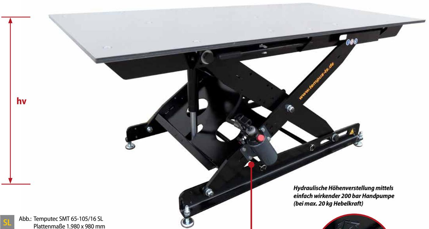
**Hydraulische Höhenverstellung mittels einfach wirkender 200 bar Handpumpe (bei max. 20 kg Hebelkraft)**
