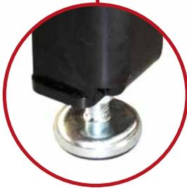
Ein Massives Untergestell aus bis zu 8 mm Kantprofil und M16 Nivellierfüßen von 0 bis 70 mm mit bis zu 2,8 kN Belastbarkeit (bitte Gesamtbelastbarkeit des Tischmodells beachten) gewährleistet einen sicheren und ebenen Stand selbst auf nicht planen Grundflächen.
