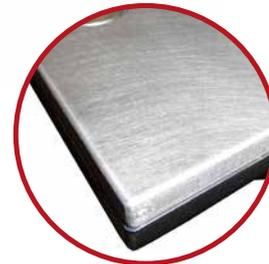
Die dual aufgebaute 12 bis 20 mm Vollmetall-Arbeitsplatte im Standard aus ST52 (Bild mit Aluminium-Oberfläche) ist mit dem Untergestell verschraubt und dadurch bei Verschleiß einfach austauschbar. Arbeitshilfen, wie zum Beispiel Schraubstöcke, Vorrichtungen sind einfach und solide montierbar.
