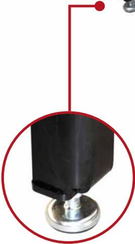
**Ein Massives Untergestell aus 8mm Kantprofil und M16 Nivellierfüßen von 0 bis 70mm mit bis zu 2,8KN Belastbarkeit (bitte Gesamtbelastbarkeit des Tischmodells beachten) gewährleistet einen sicheren Stand selbst auf unebenen Grundflächen**
